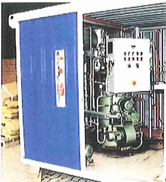
Générateur de vapeur pour la précontrainte thermique
