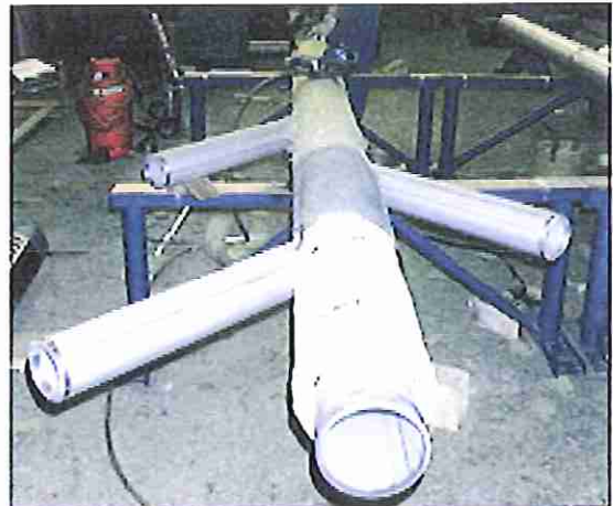
Irlande, TUBE FW DE SÉCURITÉ pour eaux usées contaminées, DN 100/200, 150/250, 100 °C, 6 bars, Tube intérieur et tube enveloppe en acier inoxydable
