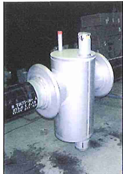
TUBE FW DE SÉCURITÉ pour eaux usées agressives, vidange au point bas, tube intérieur, tube enveloppe et compensateur lenticulaire en acier inoxydable
